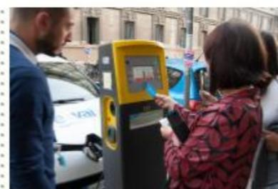
4. Appoggiare la **tessera blu** sul sensore della **colonnina** per permettere lo scollegamento del cavo
