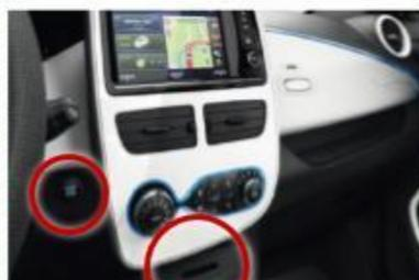
16. Per l'accensione del veicolo inserire la **chiave** nell'apposita fessura e premere il **freno** con il cambio in **posizione P**, successivamente premere il tasto **START/STOP**
