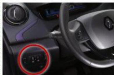
9. Una volta terminato il viaggio è **obbligatorio collegare il veicolo alla colonnina**. Premere quindi il tasto a sinistra del volante o il pulsante con spina elettrica sulle chiavi per aprire lo **sportello** della presa.
