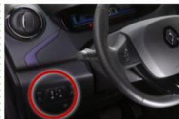
18. Una volta terminato il viaggio è **obbligatorio collegare il veicolo alla colonnina**. Premere quindi il tasto a sinistra del volante o il pulsante con spina elettrica sulle chiavi per aprire lo **sportello** della presa.
