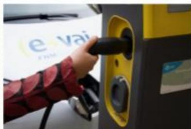
13. Collegare il cavo alla presa della colonnina di ricarica
