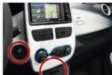
7. Per l'accensione del veicolo inserire la **chiave** nell'apposita fessura e premere il **freno** con il cambio in **posizione P**, successivamente premere il tasto **START/STOP**
